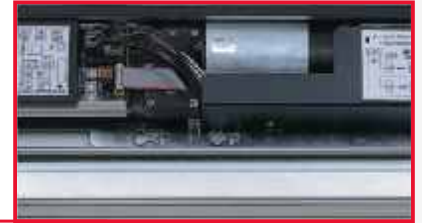
Quadro electrónico com microprocessador Carta de comando com amplificador de fotocélulas incorporado
